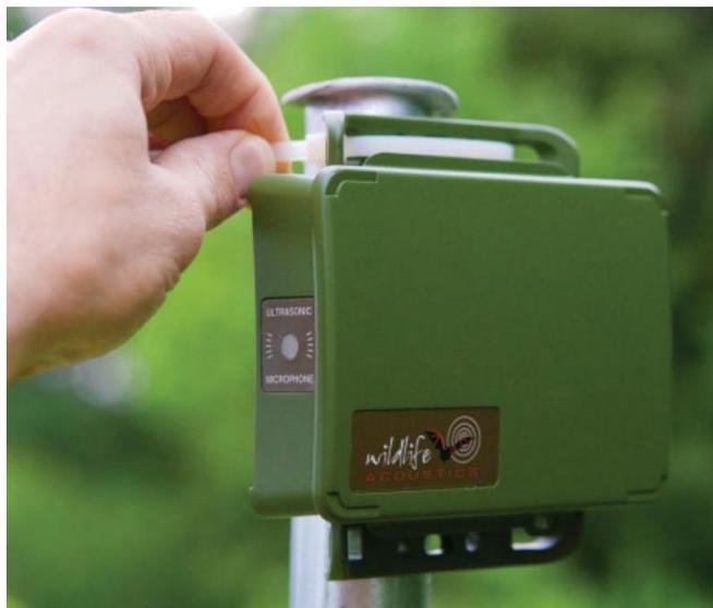
**Figure 6 : Modèle d'enregistreur passif « Song Meter Mini BAT Wildlife Acoustics » pour capter les ultrasons émis par les chiroptères (source: Song Meter Mini BAT Wildlife Acoustics (enregistreur ultra-sonore) (leclub-biotope.com)).**
