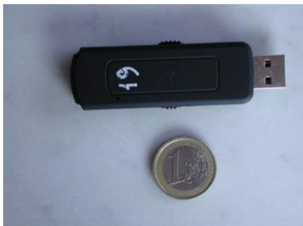
**Figure 3 : Modèle d'enregistreur acoustique à faible coût UR-09 LCR de ShenZhen HNSAT Industrial Co. Ltd (Chine) ; source de la photo : (Farina et al., 2014).**
